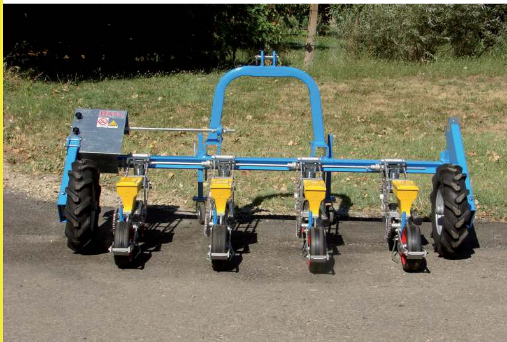
SP 2012 a quattro elementi con cambio a cinque distanze sulla fila SP 2012 su keturiais elementais, su mechaniniu reduktoriumi pakeitimui į penkis sėjimo atstumus tarp sėklų
