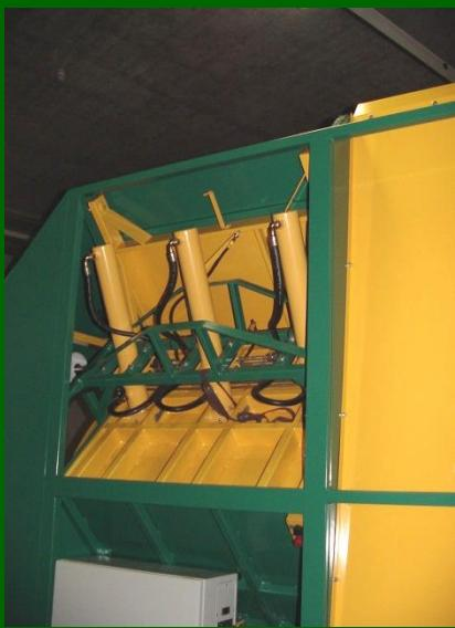
Kukurūzai yra užpilami tarp dviejų šliaužiklių. Kai visa suspaudimo kamera yra užpildyta, presavimo operacija prasideda. Du vertikalūs sutapdinti plunžeriai, kurių kiekvieno maksimali suspaudimo jėga yra  $27\,000\text{ kg}$ , supresuoja kukurūzus, siekiant padaryti norimą formą.
