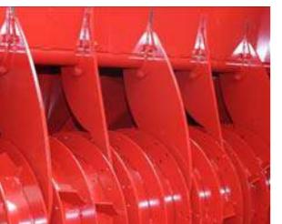
Ryšilio sulaikymas suprojektuotas, kad dirbtų su skersiniais griebtuvais, užtikrintų gerą apsivertimą, užgarantuojant pastovią aukštą dalinimo normą.
