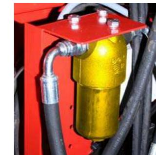
**Linijinis aukšto spūgio hidraulinis filtras** neleidžia užsiteršti hidraulinei sistemai.
