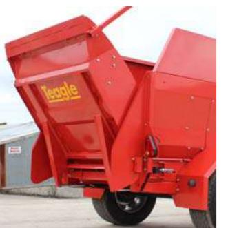
Išplatėję nuleidžiami galiniai vartai lengvam pakrovimui yra su dviem hidrauliniais cilindrais suteikiančiais stabiliumą.
