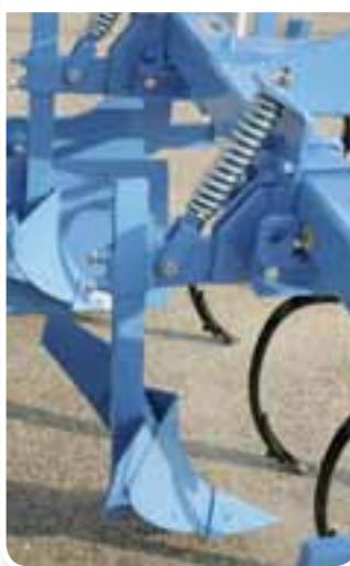
Il vibrobaulatore meccanico SPEDO crea un'ottimale forma e stabilità ai bauli sia in terreni sciolti che in terreni di medio impasto. Le molle flex, poste sulla parte anteriore del vibrobaulatore, smuovono il terreno permettendo così ai dischi o assolcatori di formare bauli regolari ed uniformi.
